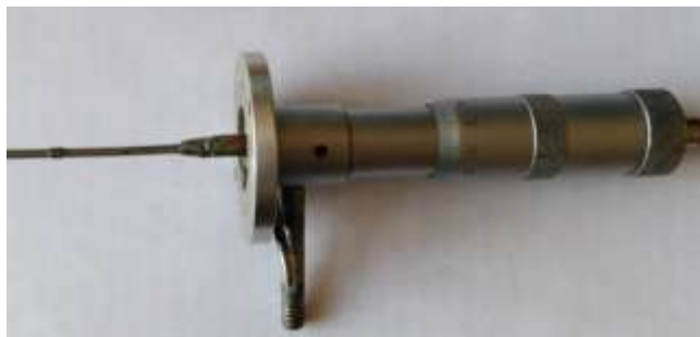
Рисунок 3 – Микрометрический винт с медицинской иглой
