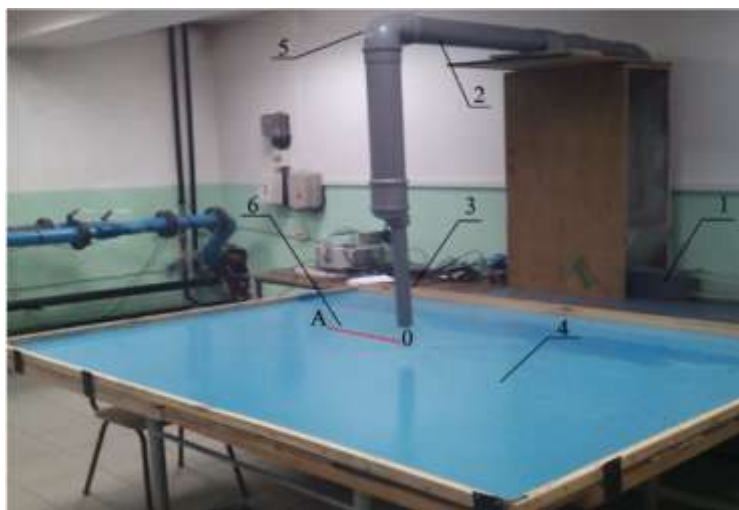
Рисунок 6 – Схема установки: 1 – турбовоздуходувка с электродвигателем; 2 – воздуховод; 3 – воздухозаборник; 4 – экран; 5 – поворотная часть; 6 – линия измерения тангенциальной скорости
