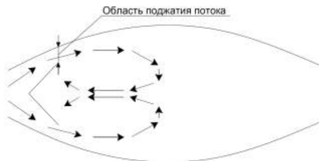
Рисунок 3 – Поджатие потока уголковым стабилизатором
