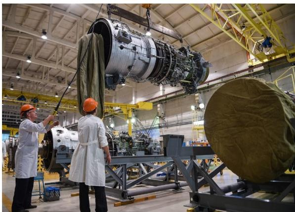
Львиную долю своей жизнедеятельности УЗГА (ранее – завод № 404 ГА) занимался ремонтом силовых установок (двигателей, редукторов и агрегатов) для вертолетов «Ми» и «Ка» конструкторского бюро Миля и Камова. Эту деятельность по ремонту авиадвигателей ТВ2-117, ТВ3-117 и редукторов ВР-8, ВР14, ВР-24, а также двигателей для транспортировки газа НК-12СТ, НК-
