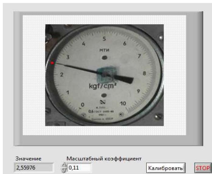
Рисунок 2. Показания оцифрованного стрелочного прибора.
