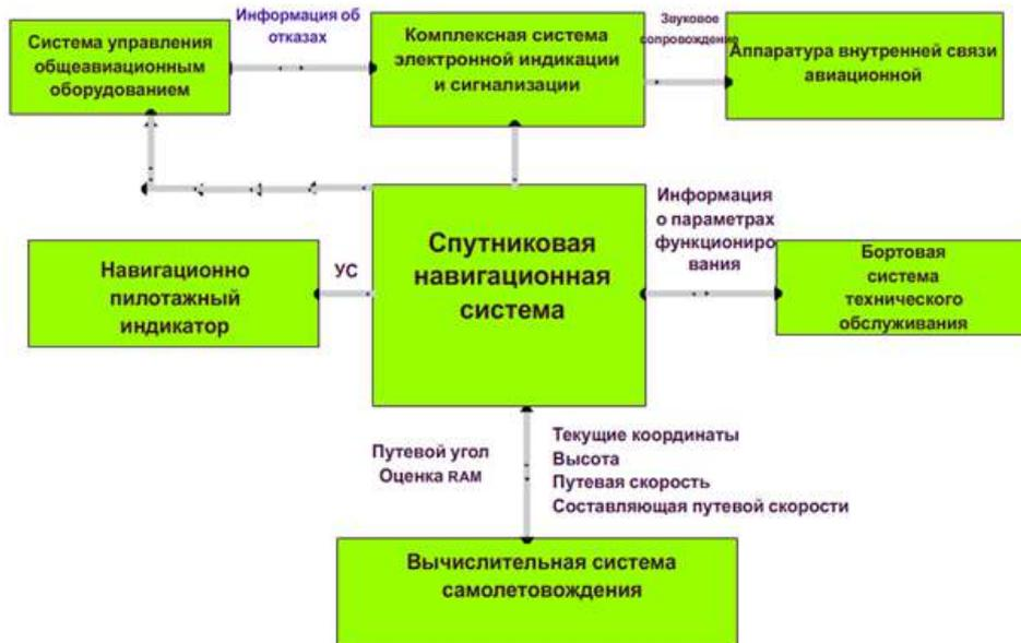
Рисунок 1. Структурная схема внешних связей аппаратуры СНС.
