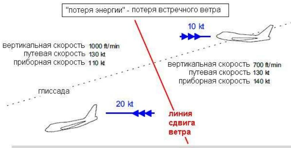
Рисунок 2. Влияние сдвига ветра на посадку ВС, приводящее к потере высоты.
