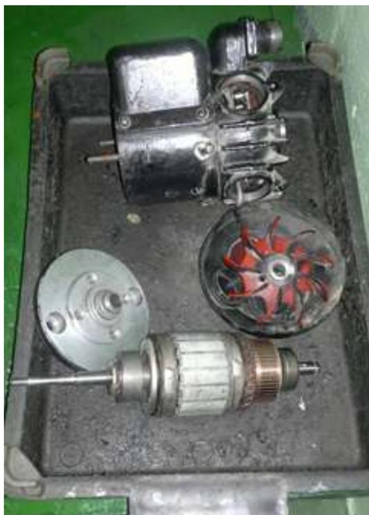
Рисунок 3. Промытые и просушенные детали и узлы электродвигателя МВ280-Б в сортовике.
