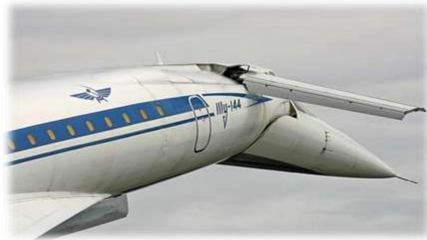
Рисунок 4. Дополнительное горизонтальное оперение на передней части фюзеляжа.
