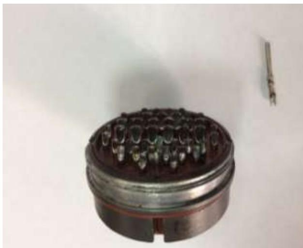
Рисунок 2. Хвостовики штепсельного разъёма.
