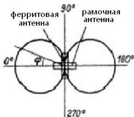
Рисунок 2. Диаграмма направленности рамочной и ферритовой антенн в горизонтальной плоскости.
