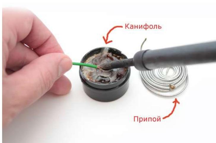
Рисунок 7. Облуживание провода.
