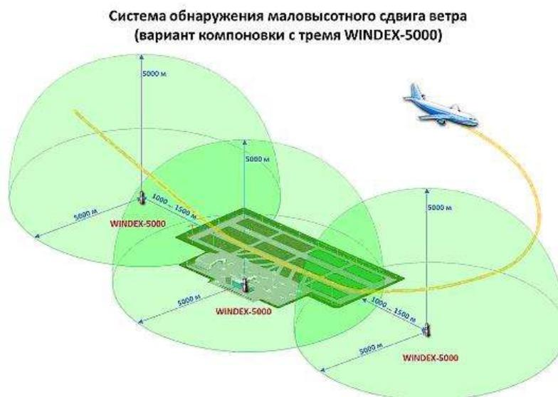
Рисунок 5. Размещение на аэродроме ИЛВ-5000.
