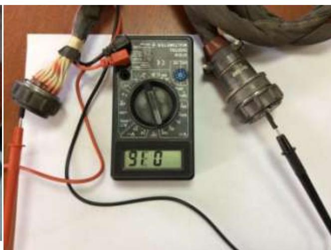
Рисунок 4. Прозвонка контактов с помощью мультиметра.
