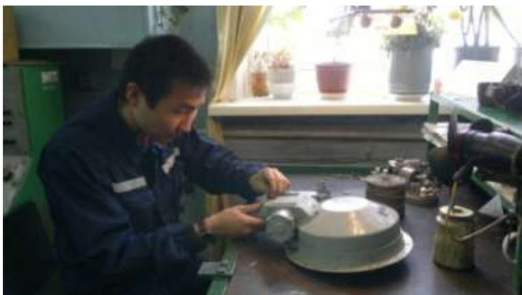
Рисунок 2. Снятие колпака электродвигателя.
