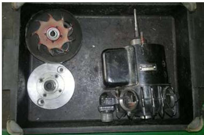
Рисунок 2. Детали и узлы электродвигателя МВ280-Б в сортовике.
