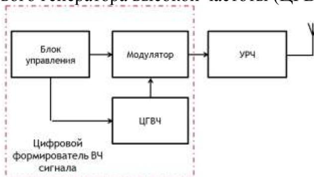
Рисунок 2. Функциональная схема цифрового радиомаяка.
