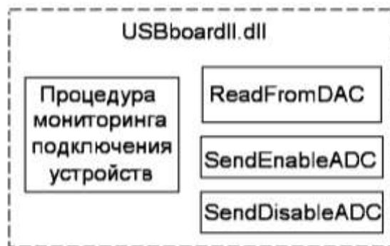
Рисунок 4. Функциональная схема библиотеки.
