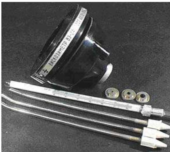
Рисунок 1. Вискозиметр ВЗ-246.
