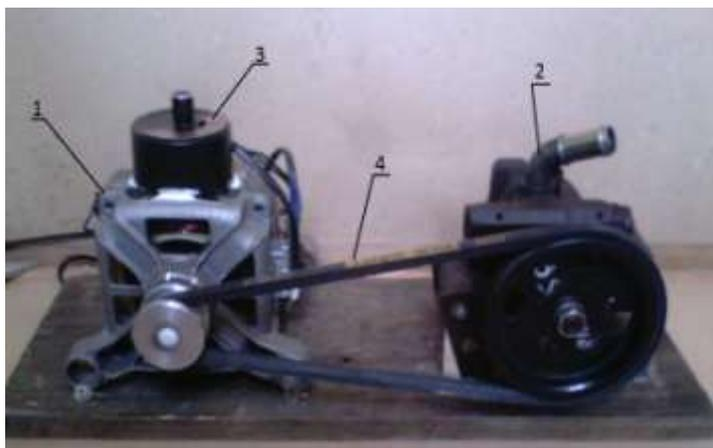
Рисунок 5. Электродвигатель с насосом :1 – электродвигатель типа МСА; 2 – насос; 3 – регулятор частоты оборотов двигателя ВМ 245; 4 –клиноремённая передача.
