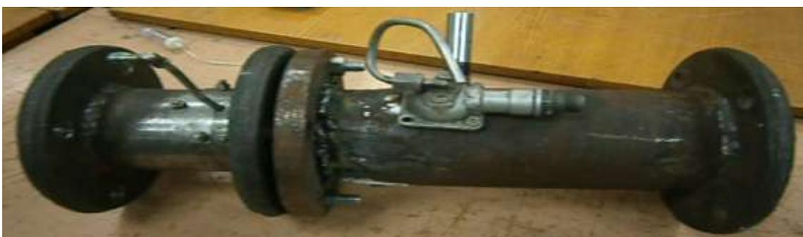
Рисунок 4. Модельная камера сгорания.
