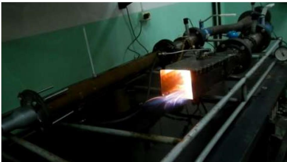
Рисунок 1. Процесс испытания модели стехиометрической камеры сгорания на камерном стенде.
