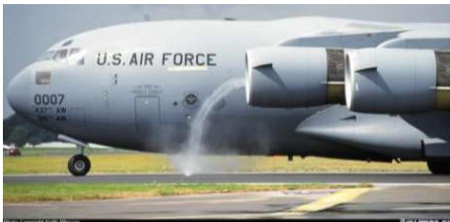
Рисунок 1. Вихрь ВЗ при работе ГТД на аэродроме [AIRLINERS.NET].
