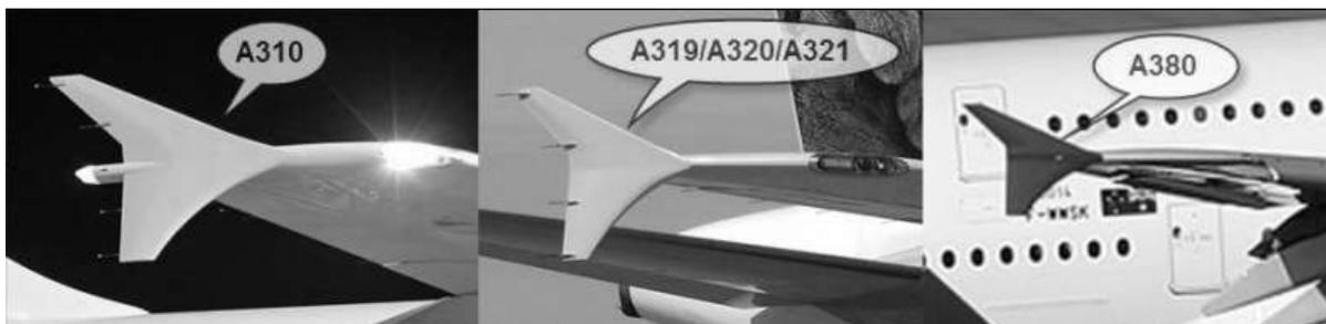
Рисунок 5. Законцовки Уиткомба на самолетах Airbus.
