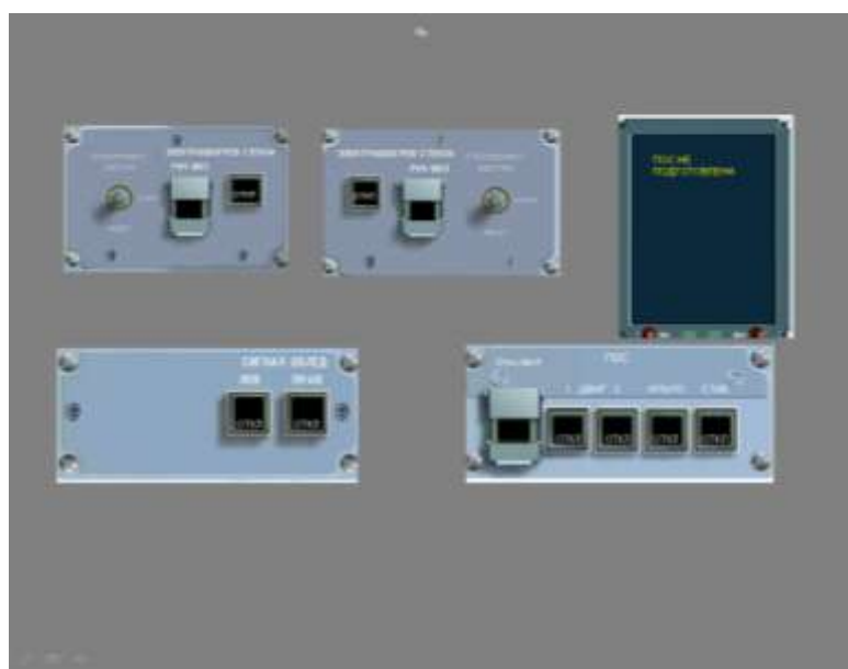
Рисунок 6 – Пульта проверки оборудования в кабине ВС
