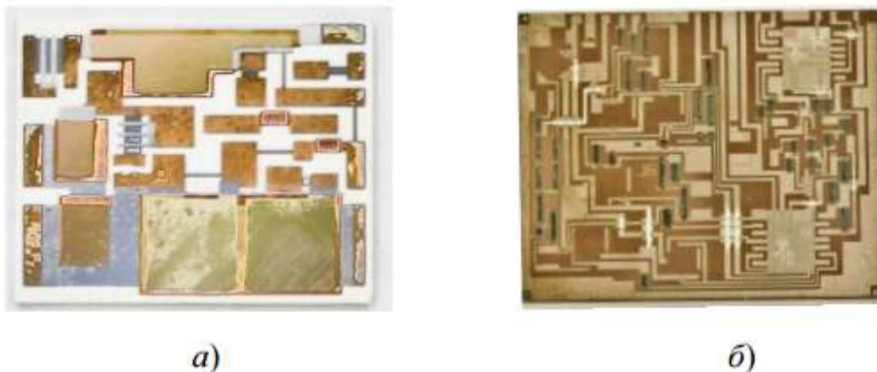
Рисунок 4 – Пленочные ИМС: а) тонкопленочная, б) толстопленочная
