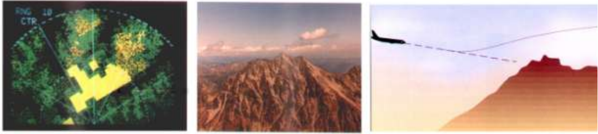
Рисунок 4 – Отображение ситуации на экране дисплея EGPWS, требующей принятия мер по уклонению от препятствия
