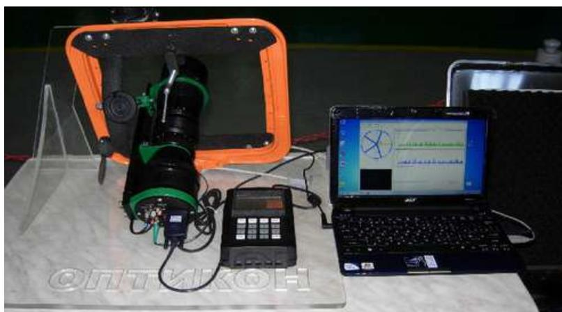
Рисунок 7 – Система регулировки несущего винта «ОПТИКОН-Вибро»
