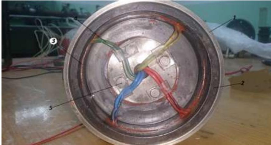
Рисунок 2 – ЧЭМТ, установленные на внутренней обойме подшипника: 1 – внутренняя обойма исследуемого подшипника; 2 – ведомый вал; 3 – ЧЭМТ-50М; 4 – провода удлинители; 5 – крепёжные болты
