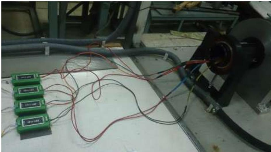
Рисунок 3 – Подключенные модули ZET 7121
