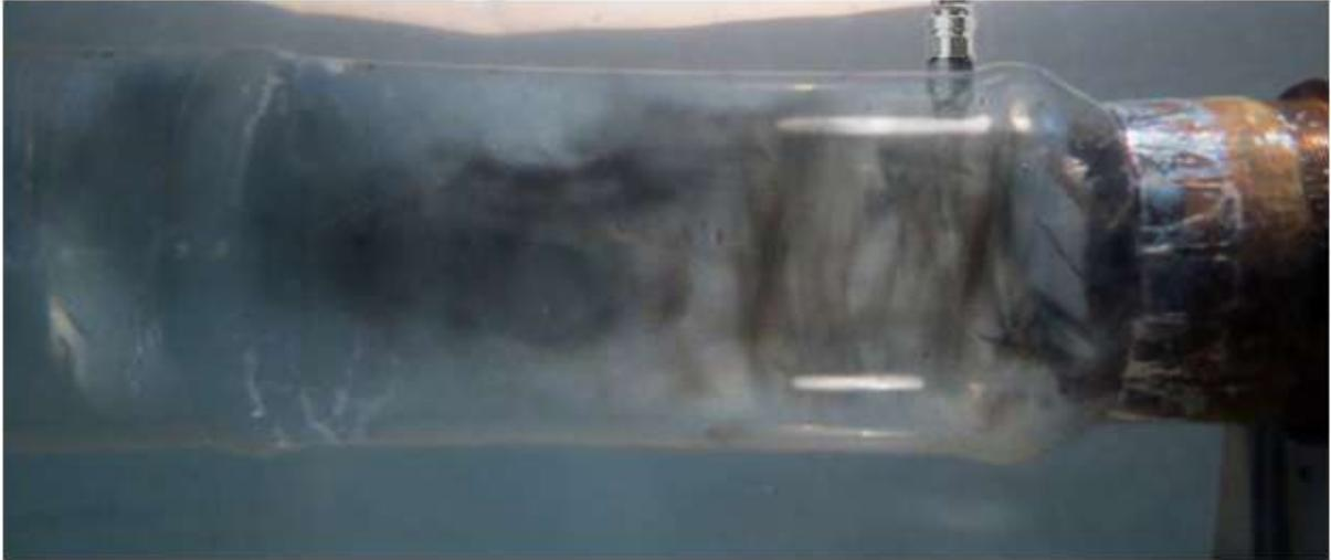
Рисунок 3 – Смесеобразование при расположении топливной форсунки на удалении менее одного относительного диаметра и впрыске в сторону обратного клапана
