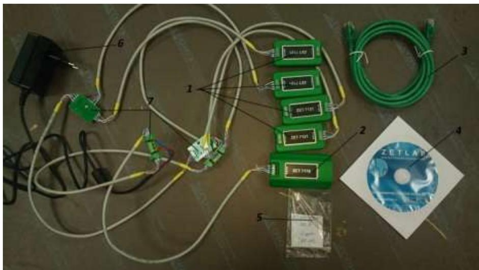
Рисунок 4 – Органы системы измерения температуры ZETLab: 1 – модуль ZET 7121; 2 – модуль ZET 7176; 3 – кабель UTP; 4 – программное обеспечение ZETLab на CD диске; 5 – ЧЭМТ 50М (4 шт); 6 – блок питания; 7 – соединительные платы
