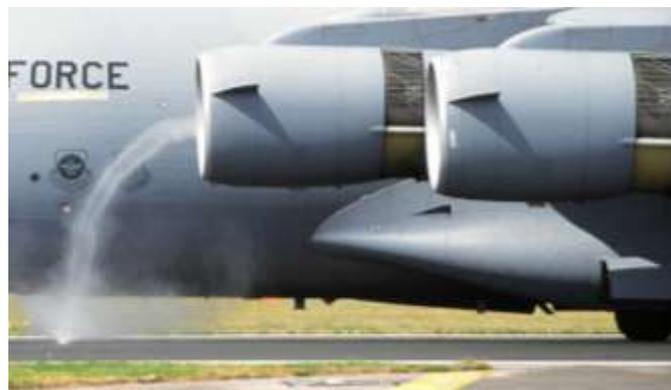
Рисунок 1 – Вихрь ВЗ при работе ГТД на аэродроме [AIRLINERS.NET]
