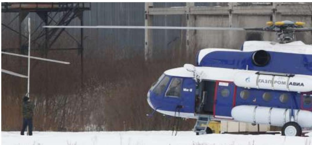
Рисунок 5 – Контактный метод «отбивки конуса» на вертолете Ми-8МТВ
