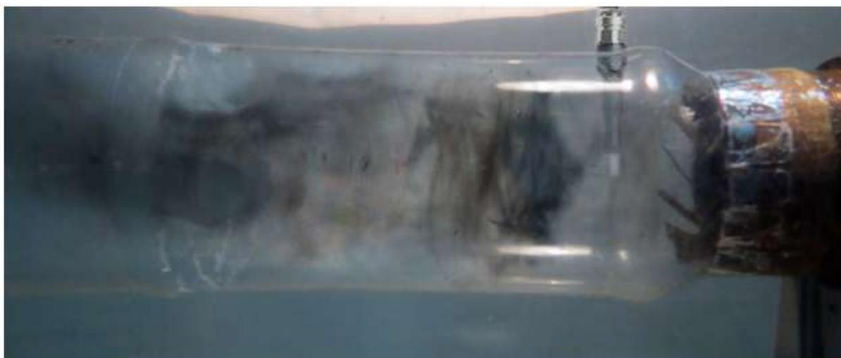
Рисунок 2 – Смесеобразование при расположении топливной форсунки на удалении менее одного относительного диаметра и впрыске в сторону сопла
