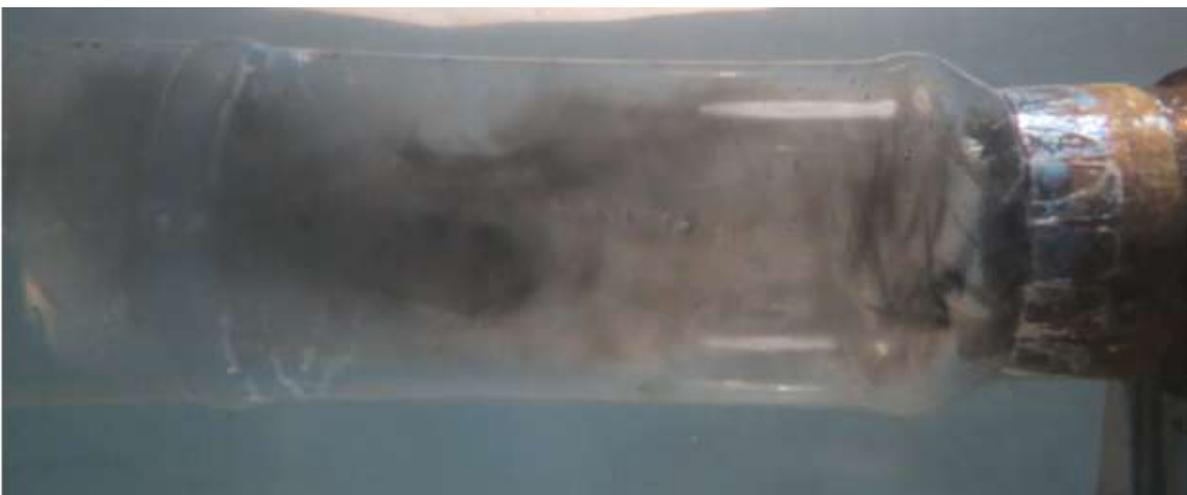
Рисунок 4 – Смесеобразование при расположении топливной форсунки перед обратным клапаном
