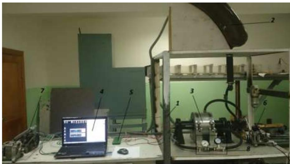
Рисунок 1 – Схема экспериментальной установки: 1 – станина; 2 – бак; 3 – объект исследования; 4 – ноутбук с ПО ZetLab; 5 – цифровые измерительные модули ZET7121; 6 – нагнетающий насос; 7 – откачивающий насос; 8 – Указатели давления и температуры масла
