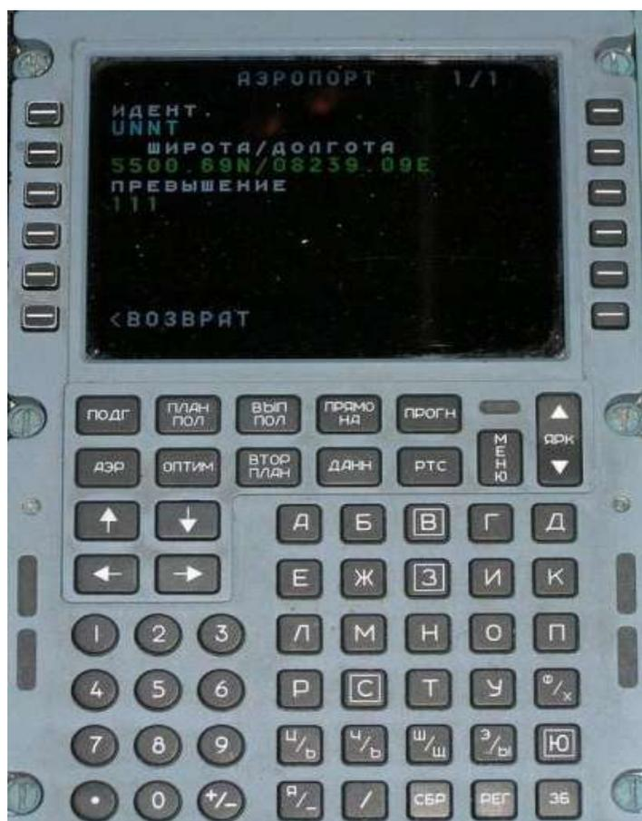
Рисунок 4 – Многофункциональный пульт управления ВСС
