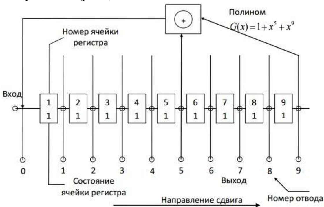
Рисунок 1 – Структурная схема регистра сдвига, формирующего дальномерный код
