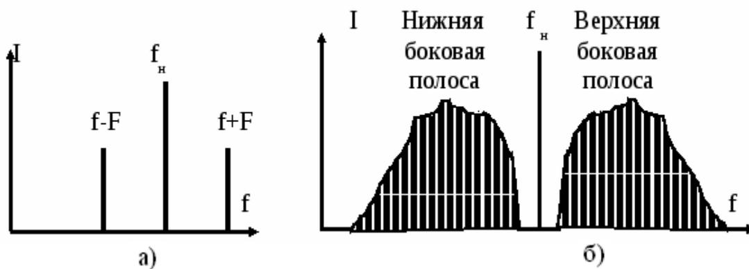
Рисунок 1 – Спектр АМ сигнала при модуляции синусоидальным сигналом (а) и голосовым (б)
