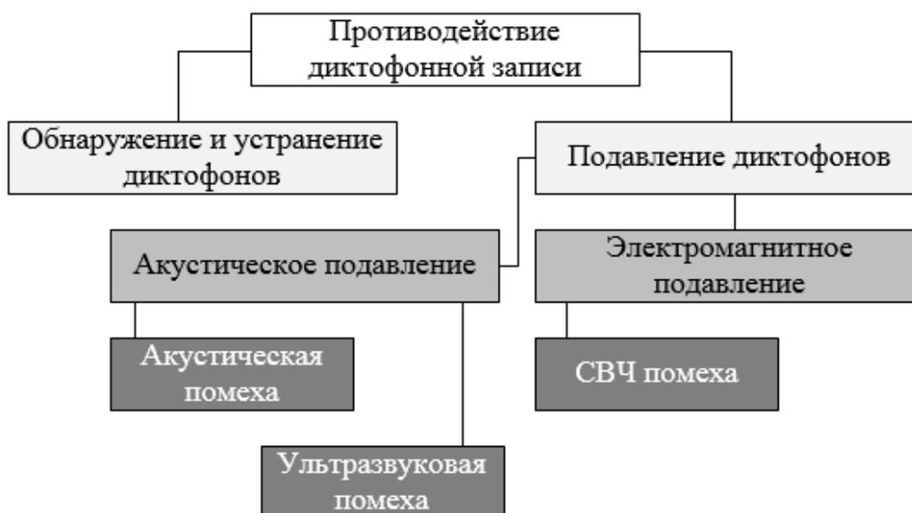
Рисунок 1 – Способы противодействия диктофонной записи
