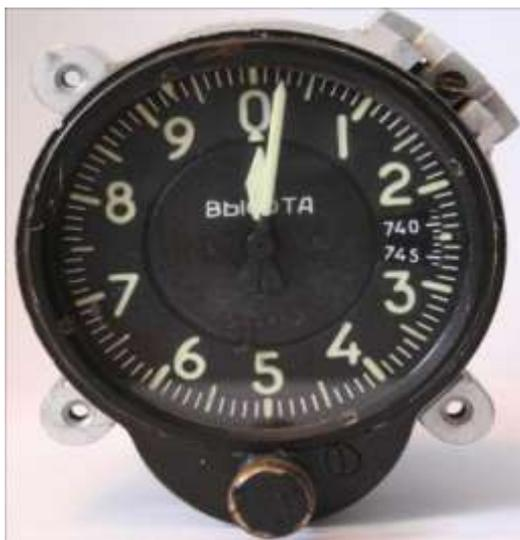
Рисунок 1 – Высотомер (ВД-10ВК)
