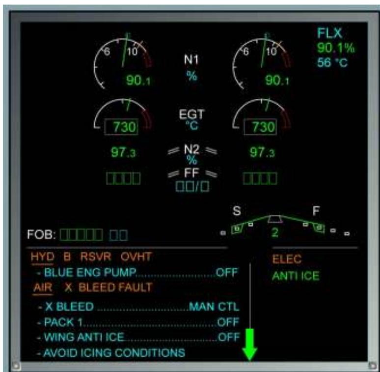
Рисунок 3 – Дисплей параметров двигателей, сообщений аварийной сигнализации (E/WD)
