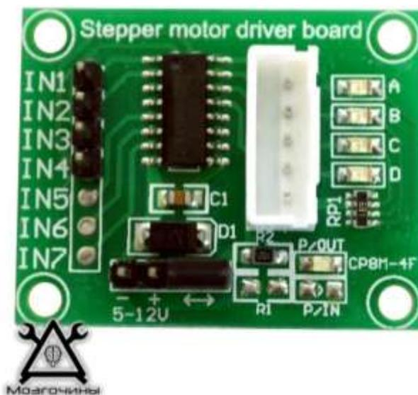
Рисунок 7 – Драйвер шагового двигателя ВУJ-48 плата ULN2003
