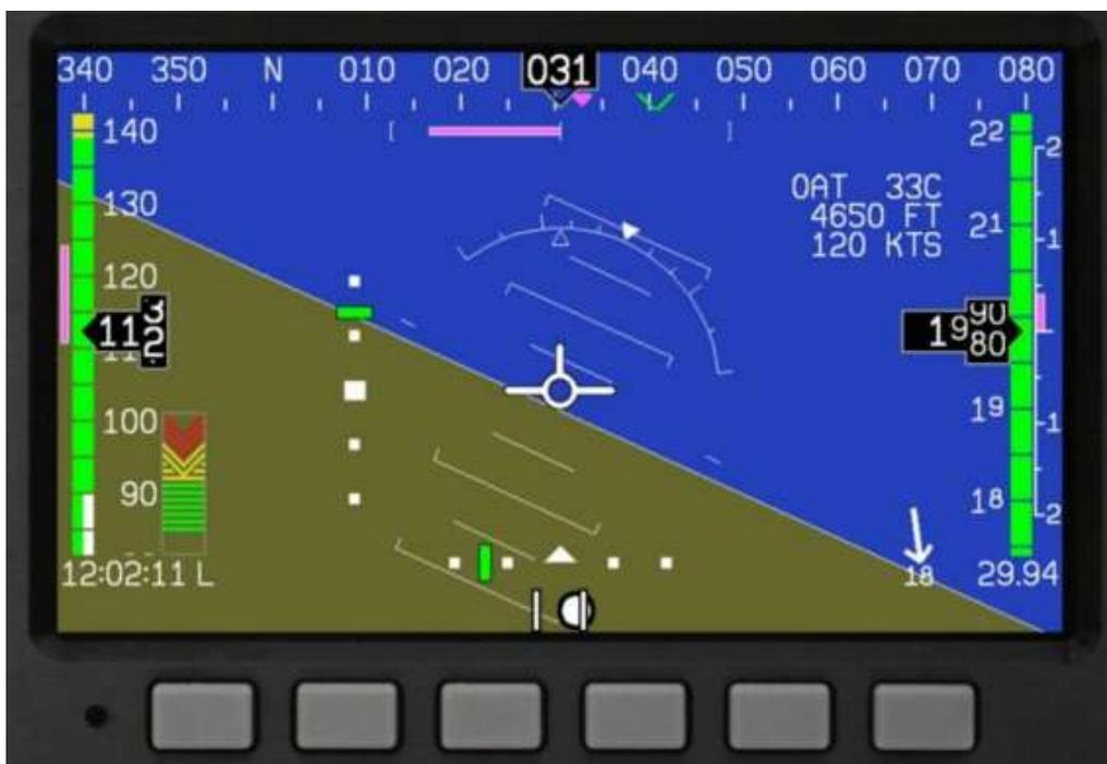
Рисунок 6 – Прибор пилотажный комбинированный резервный
