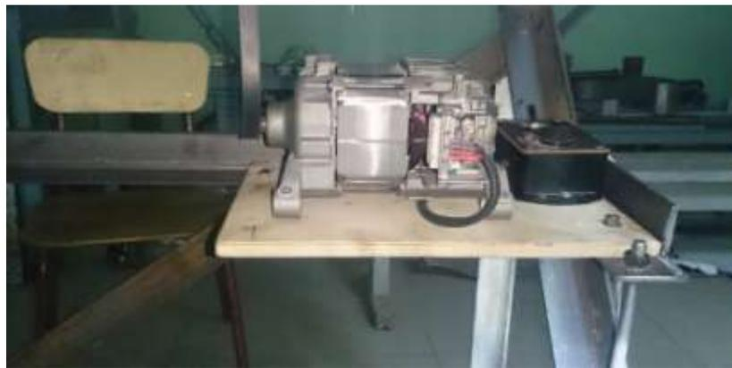
Рисунок 10 – Двигатель с регулятором оборотов
