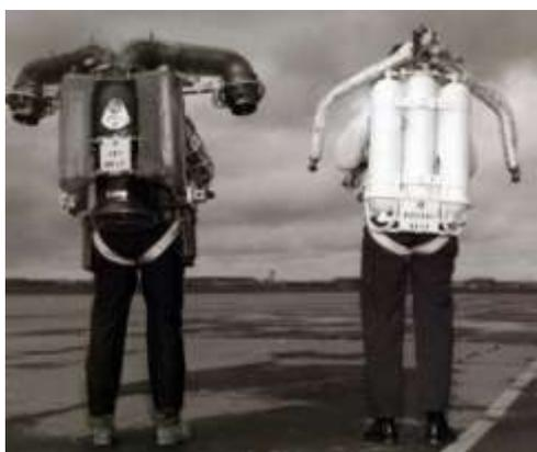
Рисунок 5 – Реактивные ранцы «Jet Belt» и «Bell Rocket Belt», разработанные Венделом Муром
