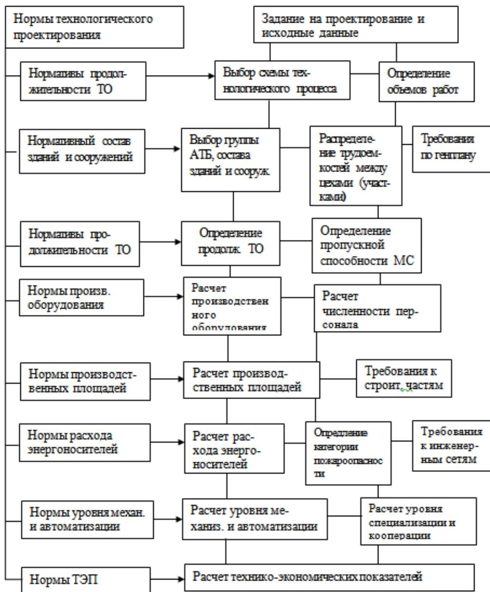
Рисунок 1 – Схема технологического процесса проектирования системы ТО и РАТ
