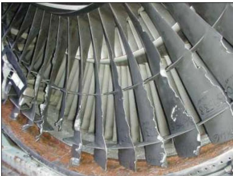
Рисунок 1 – Неремонтируемое повреждение ГТД
