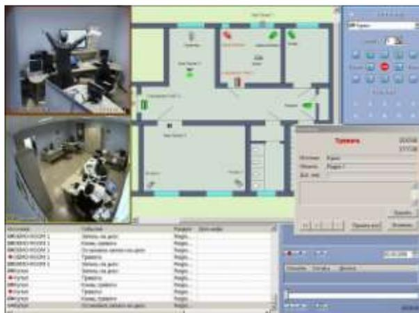
Рисунок 1 – Интегрированная система безопасности «Интеллект»
