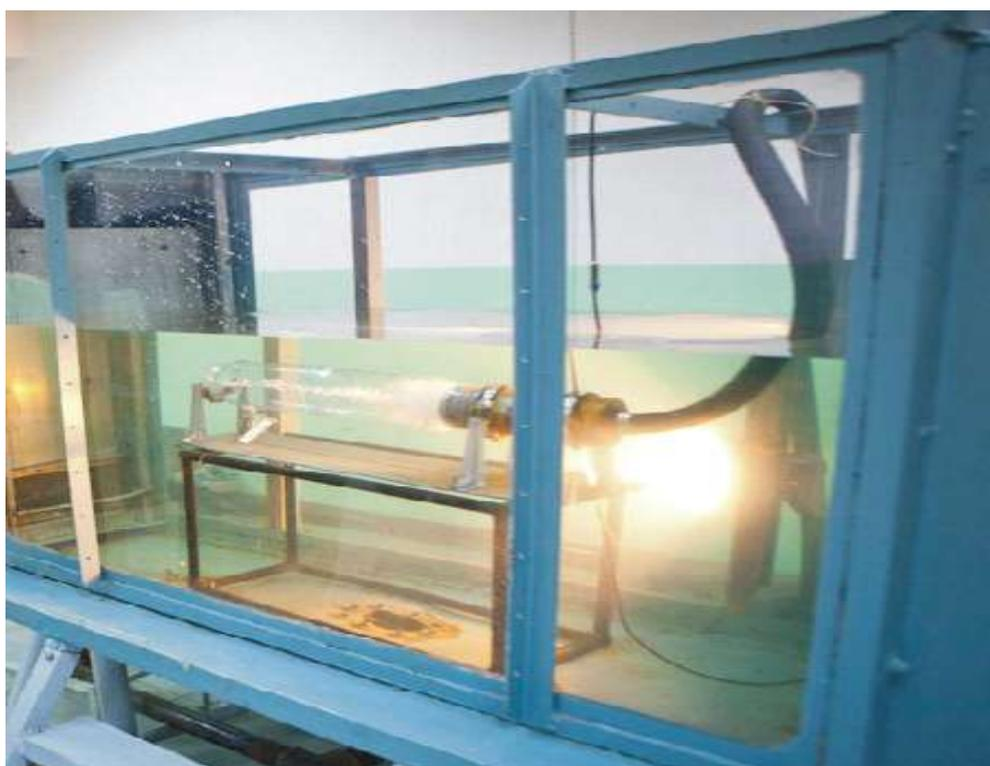
Рисунок 1 – Экспериментальная установка «Гидробассейн»
