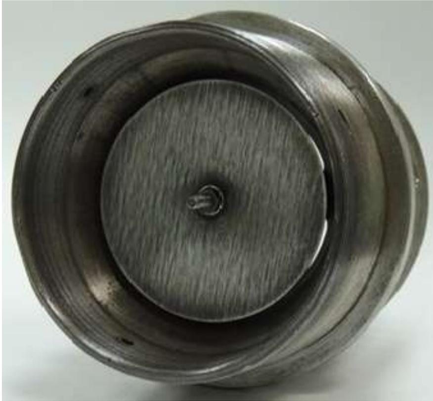
Рисунок 2 – Фронтальное устройство импульсной камеры сгорания
