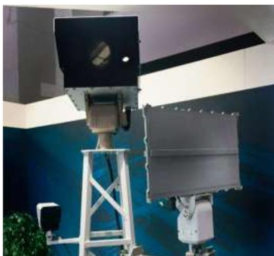
Рисунок 3 – Роботизированный радиолокационный-оптический комплекс «Полет-1»
