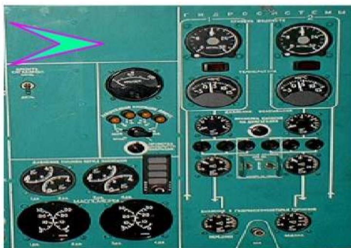
Рисунок 5 – Щиток старшего бортового техника
