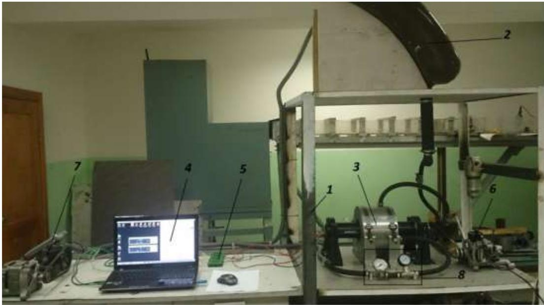
Рисунок 1 – Схема экспериментальной установки: 1 – станина; 2 – бак; 3 – объект исследования; 4 – ноутбук с ПО ZetLab; 5 – цифровые измерительные модули ZET7121; 6 – нагнетающий насос; 7 –откачивающий насос; 8 – указатели давления и температуры масла
