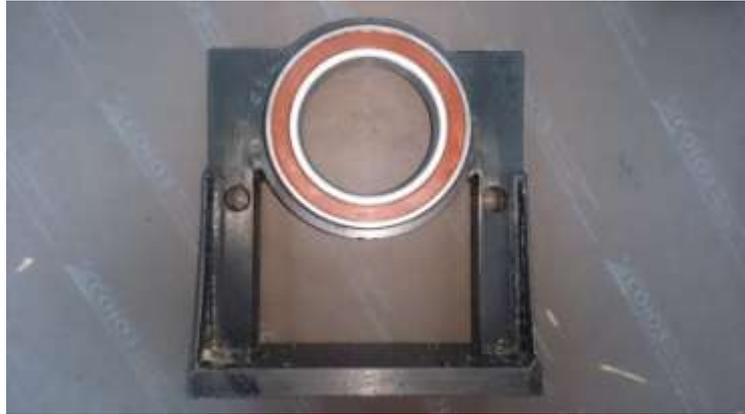
Рисунок 9 – Подшипник в корпусе
