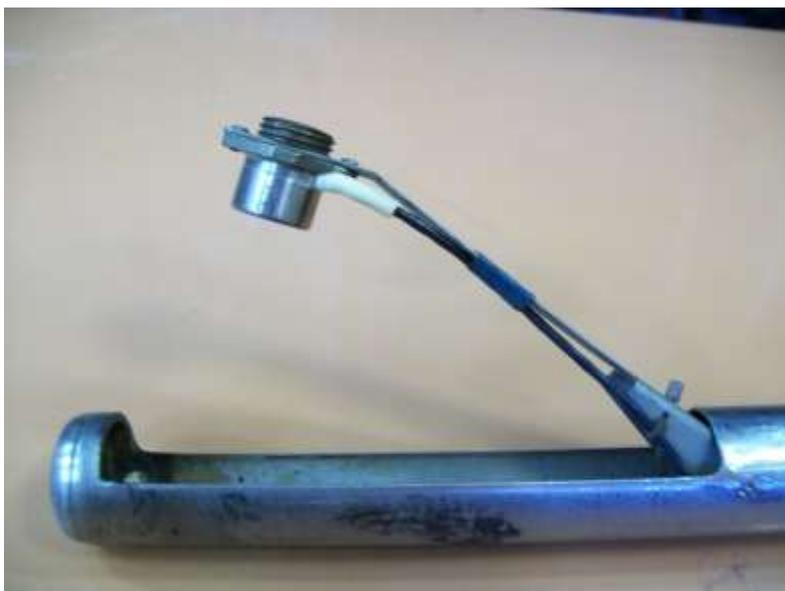
Рисунок 2 – Вибродатчик, размещенный на штанге
