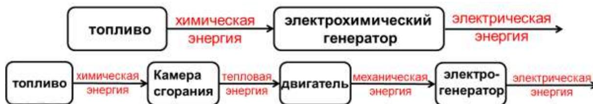
Рисунок 2 – Этапы преобразования химической энергии топлива в электрическую
