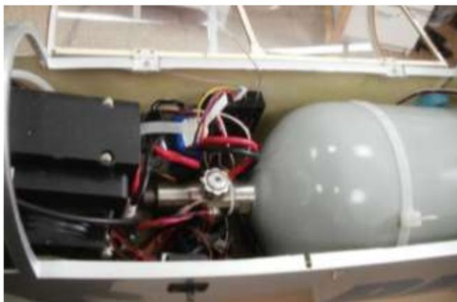
Рисунок 1 – Фрагмент бортовой энергоустановки на твердополимерном топливном элементе отечественного производства
