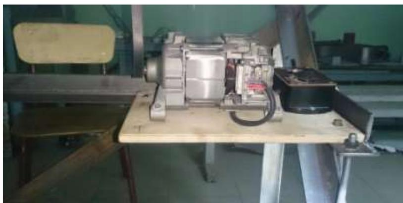
Рисунок 4 – Двигатель с регулятором оборотов
