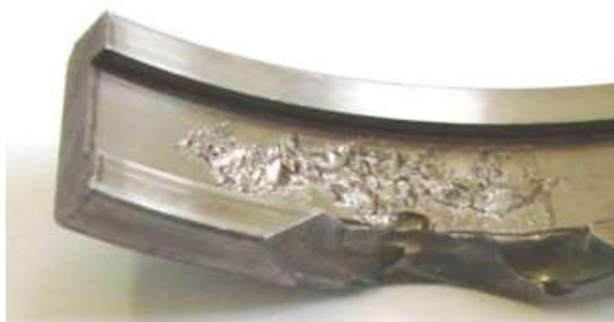
Рисунок 1 – Характерные повреждения подшипника
