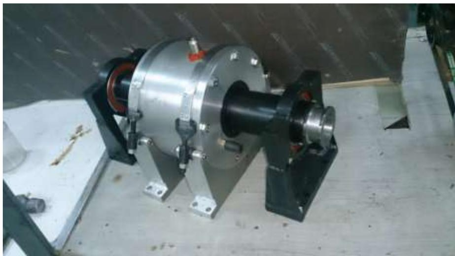
Рисунок 2 – Узел межвального подшипника в сборе
