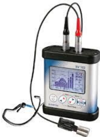
Рисунок 1.7 – Шумомер, анализатор спектра 1-го класса точности SV-102
