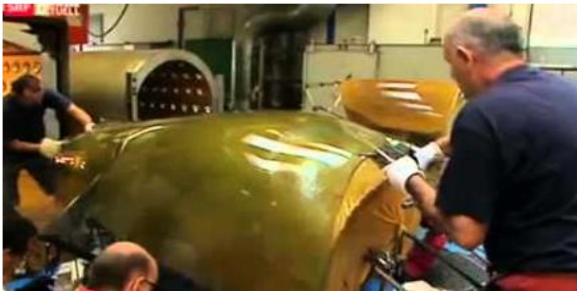
Рисунок 1 – Изготовление литого органического остекления ВС
