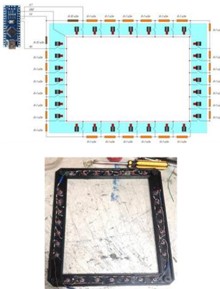
Рисунок 4 – Принципиальная схема подключения кнопок к микроконтроллеру и фото с размещенной электрической цепью в корпусе МФЦИ
