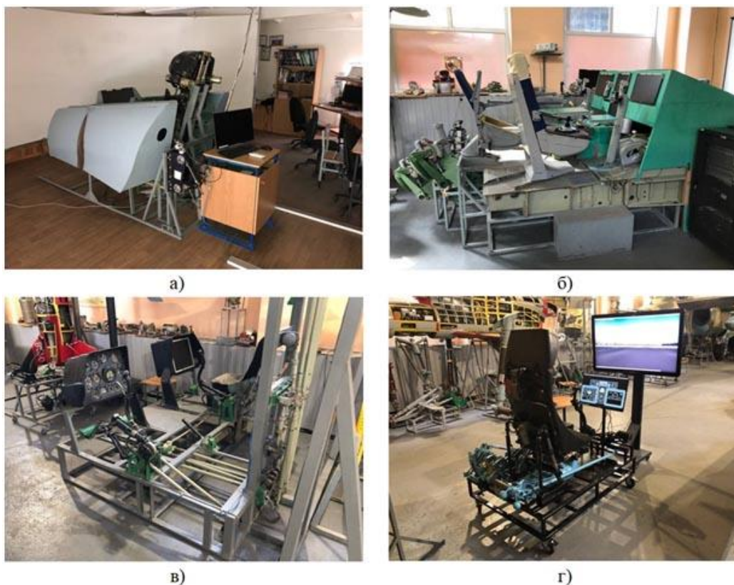
Рисунок 1 – Пилотажные стенды кафедры авиационных комплексов и конструкции летательных аппаратов: а) маневренной авиации; б) не маневренной авиации; в) стационарный вертолетный стенд; г) мобильный вертолетный стенд
