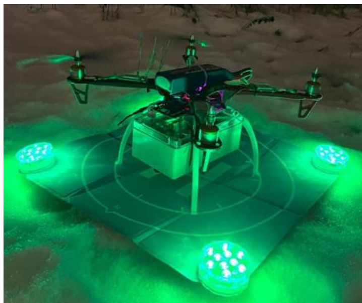
Рисунок 1 – Комплект наземного и бортового оборудования системы оптико-электронного позиционирования
