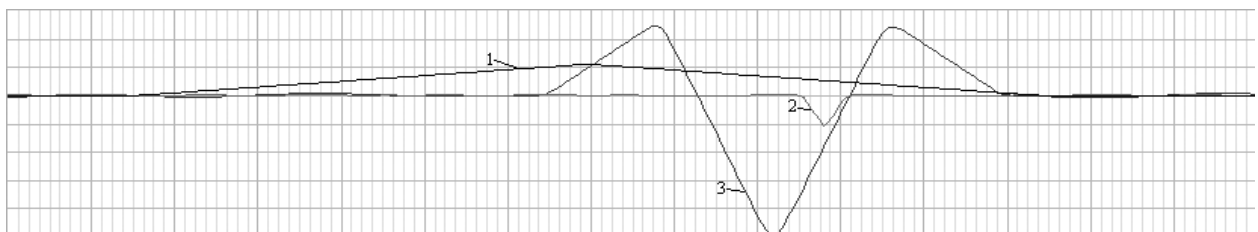
Рисунок 6 – Сравнение корреляционных откликов: 1 – частотное разделение L1, 2 – кодовое разделение L3, 3 – кодовое разделение L2
