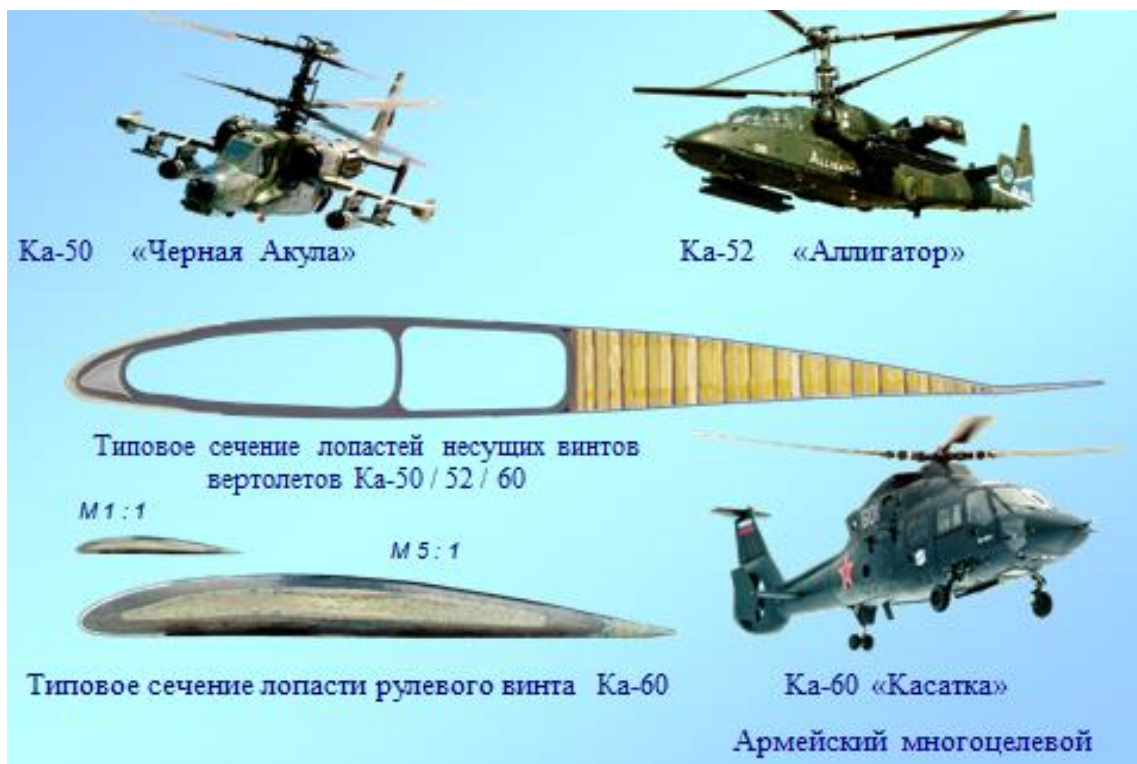
Рисунок 5 – Типовые сечения лопастей из ПКМ несущих и рулевых винтов вертолетов семейства «КА»
