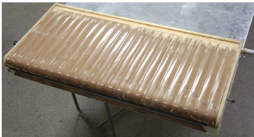
Рисунок 11 – Формовочная матрица с рубильниками, поддерживающими обшивку при формовке
