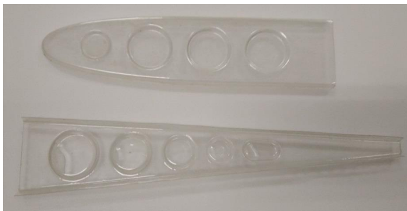
Рисунок 8 – Готовые компоненты нервюры
