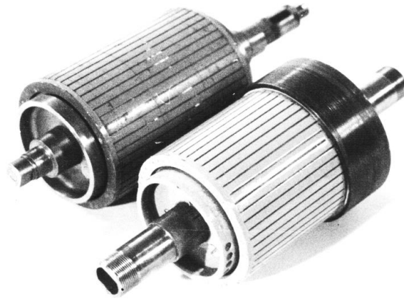
Рисунок 2 – Внешний вид ротора с напрессованной гильзой и без нее
