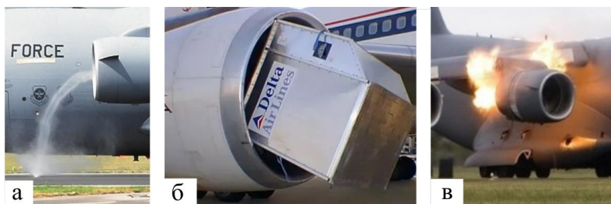
Рисунок 2 – Проблемы, порождаемые вихреобразованием: а – вихрь под воздухозаборником ГТСУ, Источник: https://i.stack.imgur.com/u9AZW.jpg ; б – засасывание постороннего предмета в воздухозаборник ГТД, Источник: https://qph.cf2.quoracdn.net/main-qimg-41c3e39f36129d2892d8369c1d2bfa0c.webp ; в – помпаж двигателя, Источник: http://samoleting.ru/wp-content/uploads/2017/05/pompazh-dvigatelya-samoleta-cto-eto1-e1494338277786.jpg
